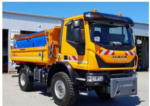
ein Ausstellungsfahrzeug der Marke IVECO für Messen beschafft werden, welches über die benötigte Ausstattung verfügt und zwischenzeitlich mit den vom Unimog vorhandenen Anbaugeräten aufgerüstet wurde. Es handelt sich um einen „Eurocargo 4x4“ mit extrem geländetauglicher Singlebereifung, Allradantrieb und einer im Verhältnis zur Fahrzeuggröße sehr großen Ladefläche. Dieses Fahrzeug wird u.a. für den Materi-
